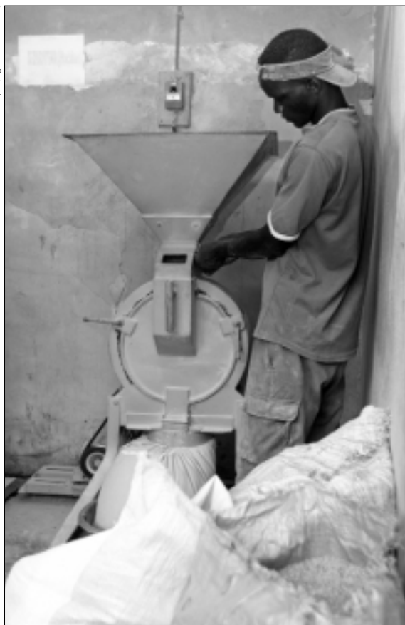
Broyeur à marteaux dans une unité de transformation du mil à Dakar (Sénégal).
